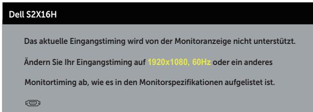
Das bedeutet, dass sich der Monitor mit dem vom Computer empfangenen Signal nicht synchronisieren kann. Siehe [Technische Daten des Monitors](#) für die horizontalen und vertikalen Frequenzbereiche, die für diesen Monitor adressierbar sind. Empfohlener Modus ist 1920 x 1080.
