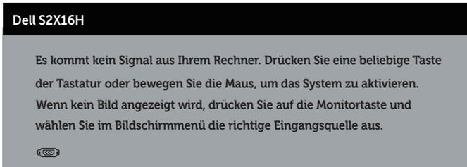
Ist das VGA- oder HDMI-Kabel nicht angeschlossen, erscheint ein schwebendes Dialogfenster, siehe unten. Der Monitor ruft nach 5 Minuten den Energiesparmodus auf, wenn er in diesem Zustand belassen wird.
